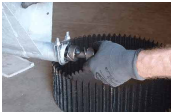
Obrázek 6-3: Vytažení upínacího hřídele
