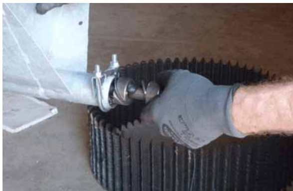
Obrázek 6-8: Aretace upínací hřídele
