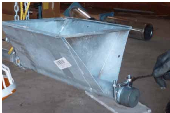
Obrázek 6-9: Upevnění upínací hřídele
